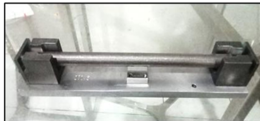
Gambar 16. Pengecekan Diameter Menggunakan Gauge Panjang
