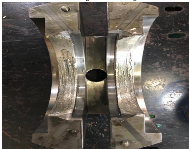
Gambar 8. Temuan Kerusakan Pada Journal Bearing
