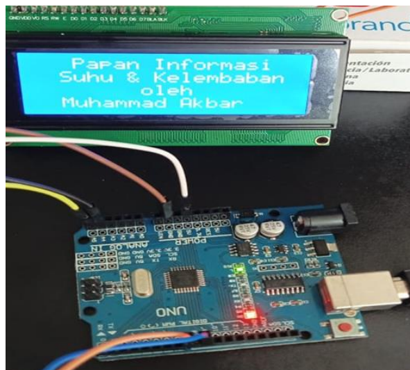
Gambar 7. Pemasangan Modul LCD
