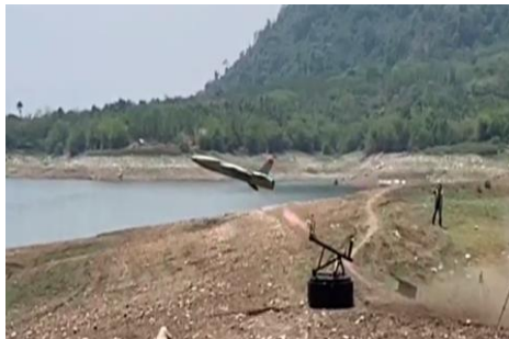
Gambar 4. Uji Stand dengan Real Rocket Booster dan Dummy Rudal Petir 18.
