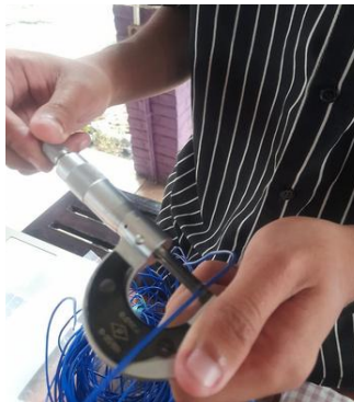
Gambar 4. Pengukuran diameter filamen menggunakan caliper
