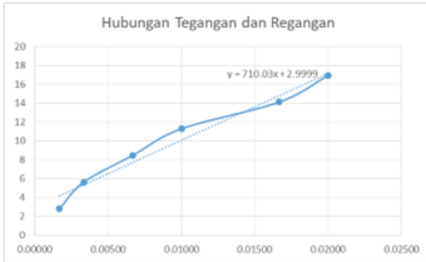
Gambar 10. Hasil Pengujian Modulus Elastisitas Beton Normal
