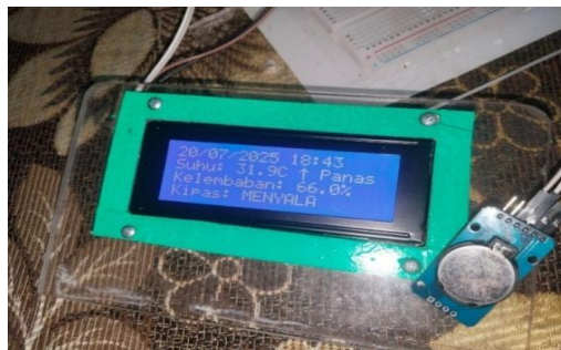
Gambar 10. MCU dan RTC Module
