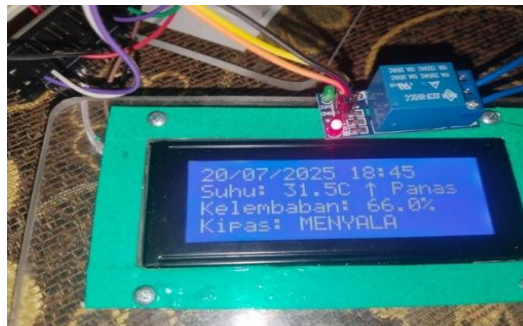
Gambar 11. MCU dan Relay module
