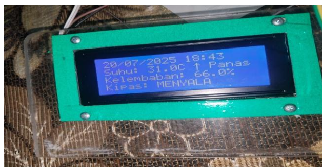
Gambar 20. LCD menampilkan monitoring suhu
