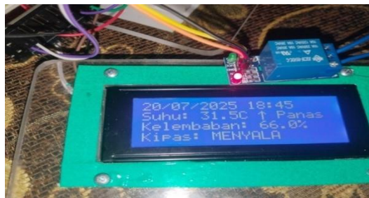
Gambar 22. Relay module 5v aktif Sumber: Hasil Penelitian (2025)
