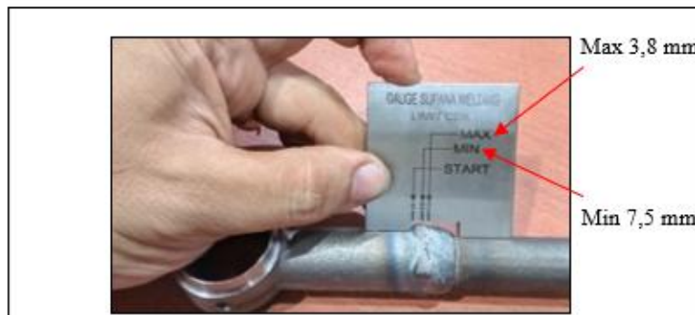
Gambar 26. Gauge Welding, alat untuk mengukur batas hasil pengelasan Sumber: Dokumentasi internal PT. Indo Integral Sekawan, 2024
