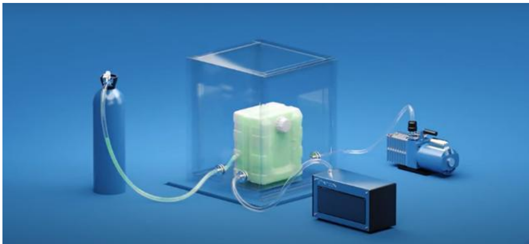
Gambar 13. Helium dimasukan melalui inlet
