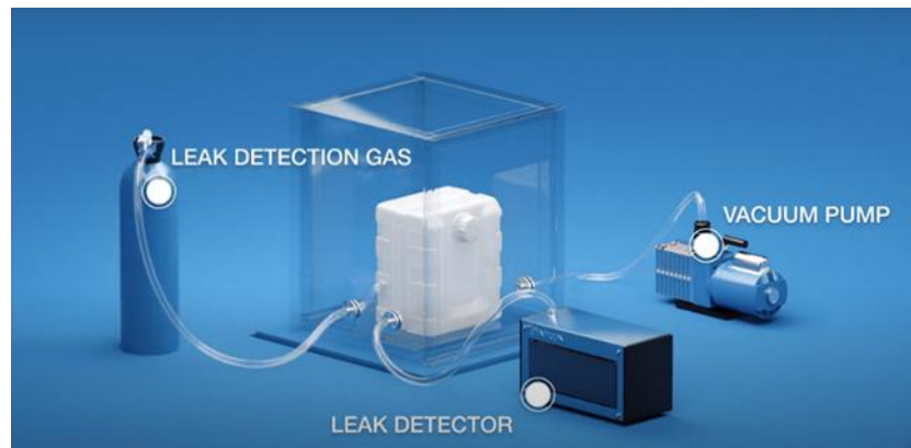
Gambar 10. Komponen utama Helium Leak Test
