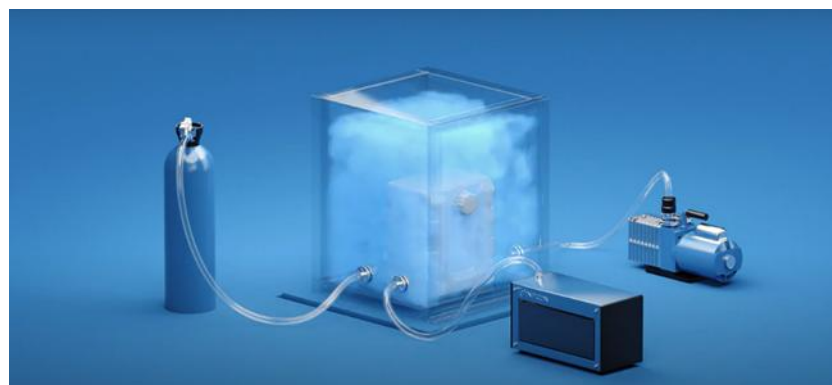
Gambar 11. Vacum pump menyerap udara dan gas dalam chamber
