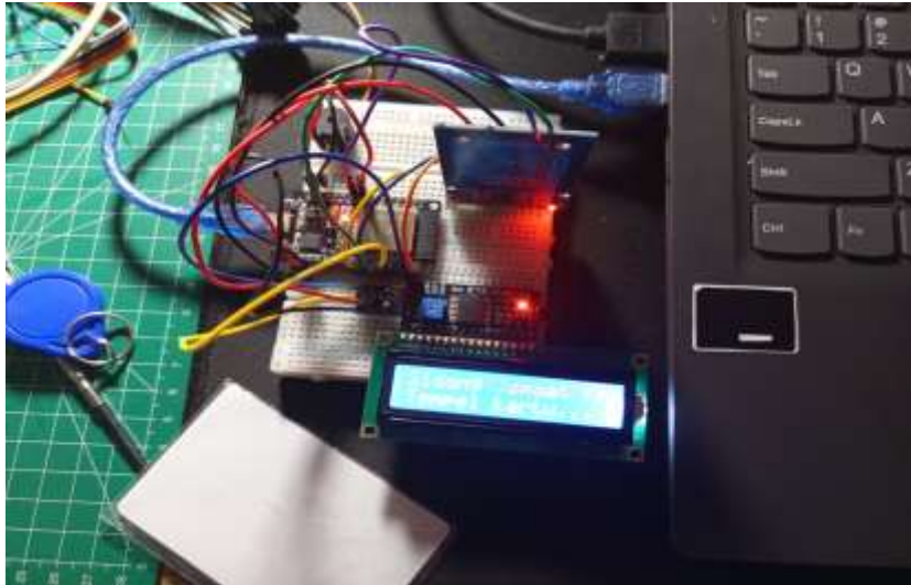
Gambar 5. Purwarupa Fisik Alat Presensi Berbasis RFID
