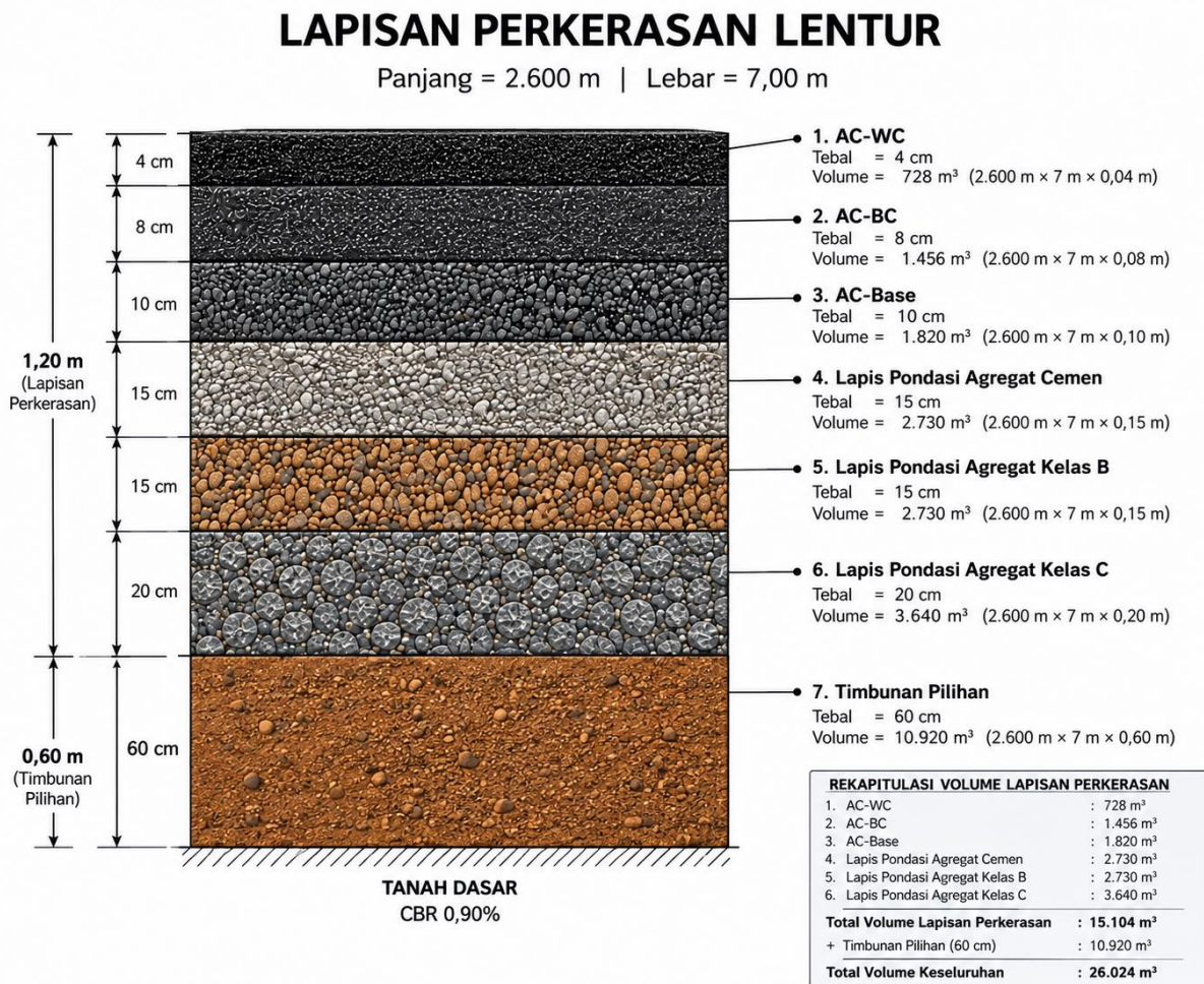
Gambar 2. Desain Struktur Perkerasan Lentur
