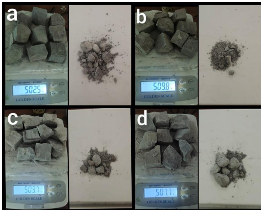
Gambar 1. Sampel batuan awal dan setelah pengujian pada pH 3,7
