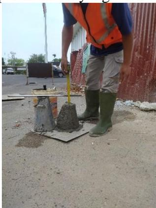
**Gambar 14 Proses Uji Slump pada Proyek**
